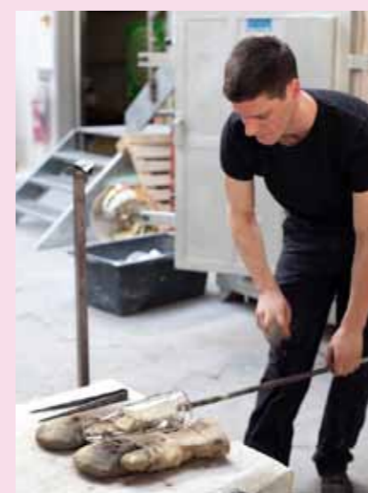
11 Die Karaffe wird von der Stange gelöst.
