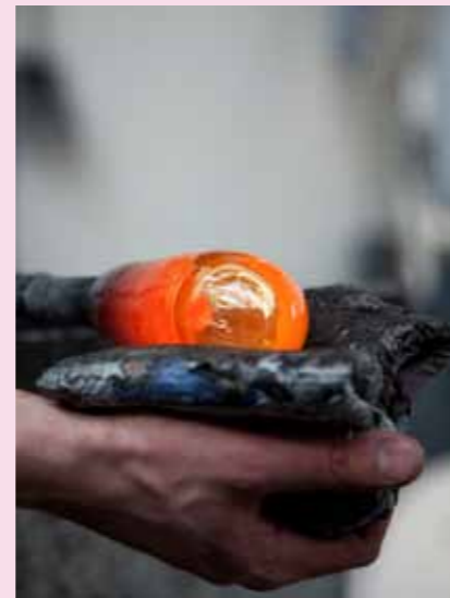
... und durch Drehen über einen Papierlappen wird es in eine erste Form gebracht.
