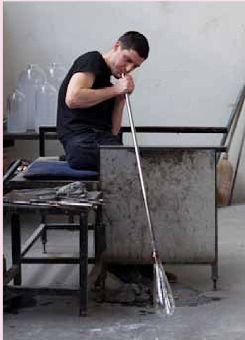
3 Mit dem Blasen entsteht Volumen.
