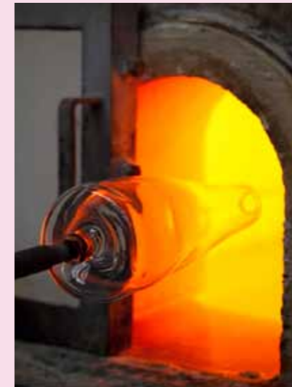
9 Das Glas wird ein weiteres Mal erhitzt.
