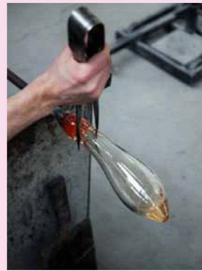
5 Mit einer Zange wird dann der Flaschenhals herausgearbeitet.
