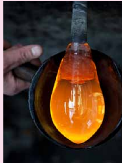
2 In einer mit Wasser gefüllten Holzform ...
