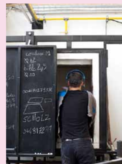
12 Mit Schutzkleidung stellt Matteo die Flasche in den 500 Grad heißen Abkühlöfen.
