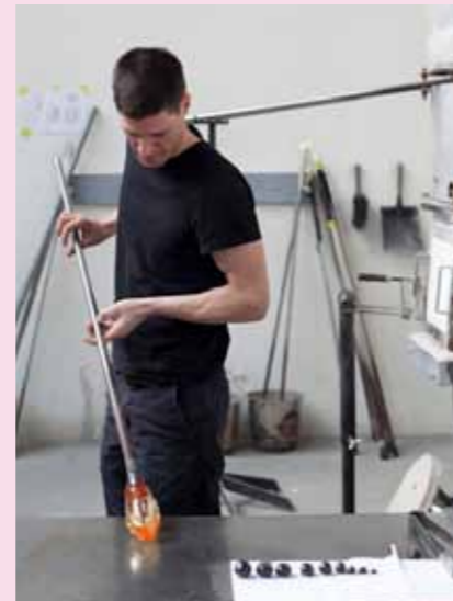
4 Nach mehrmaligem Erhitzen, Blasen und Drehen formt Matteo das Material auf der Tischfläche.
